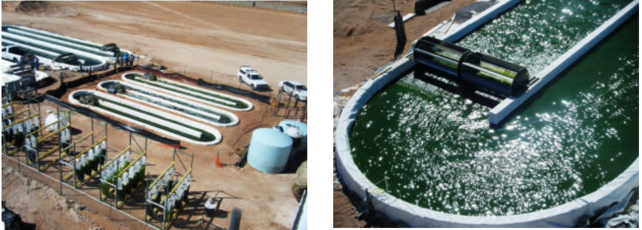
Figure 3 : Bassins ouverts de type raceway de la société SAPHIRE Energy, Las Cruces, Nouveau Mexique, Etats-Unis.
